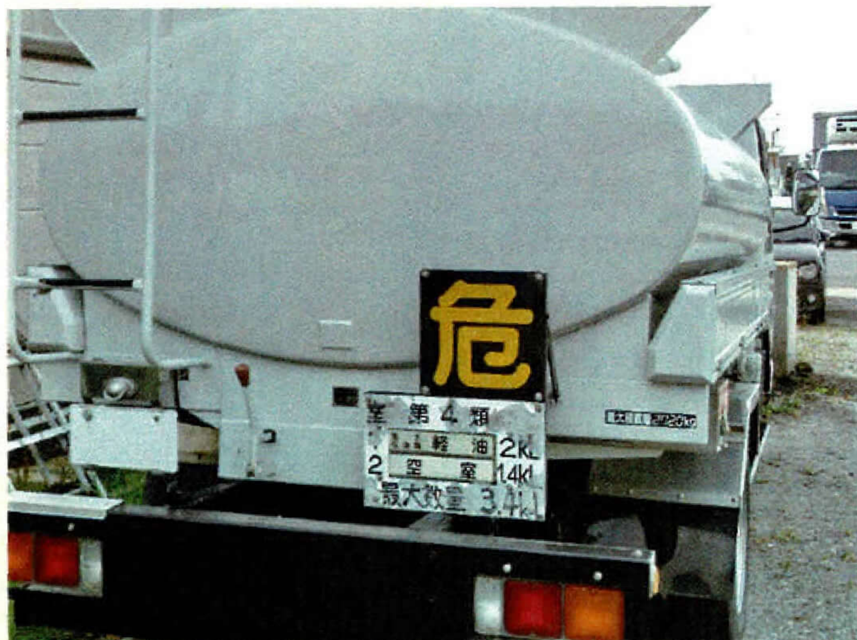
さび止め処理し、20年が経過したタンクローリー
