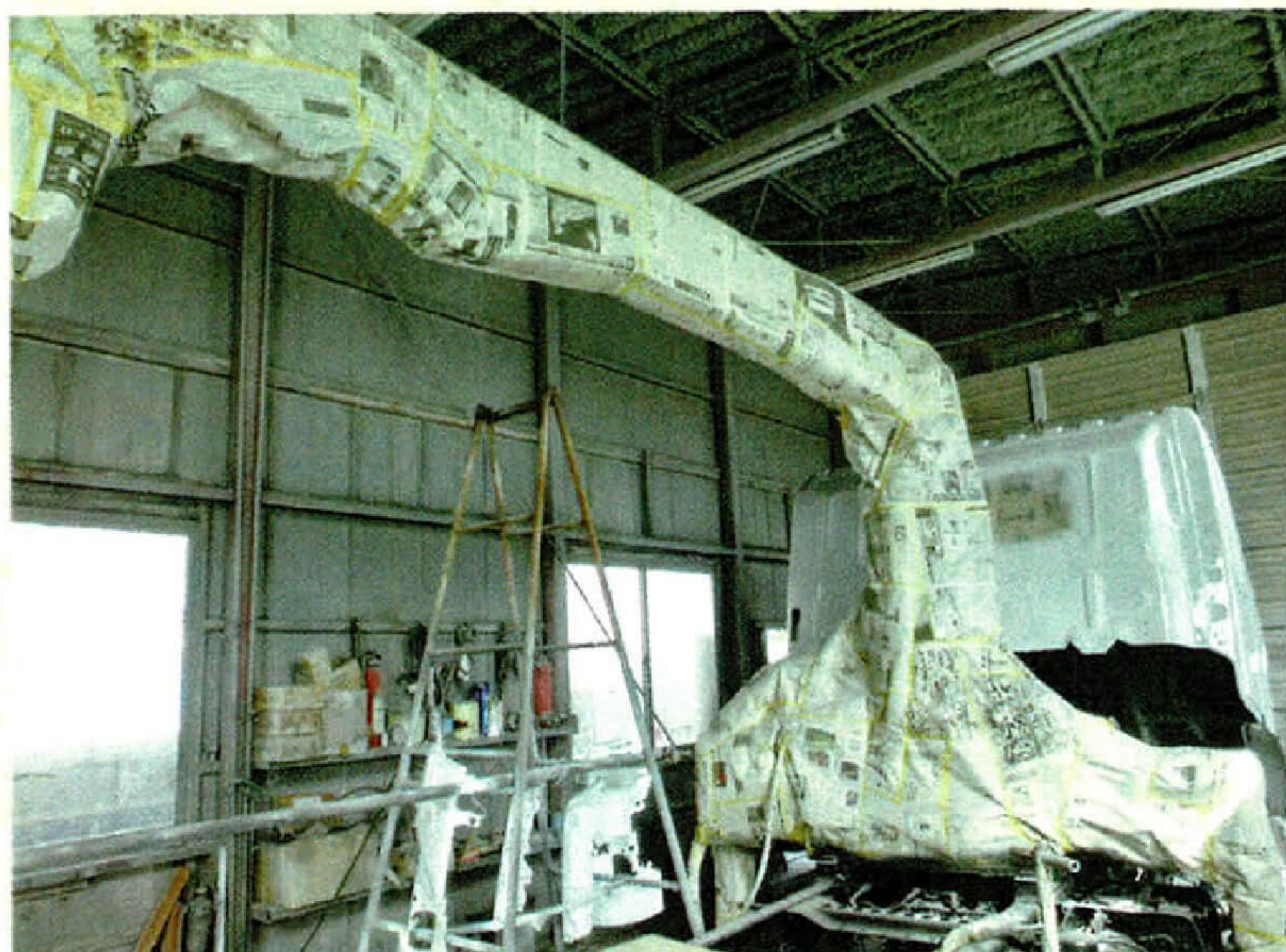
さび止め加工中のクレーン車
